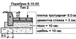
Конструкція тротуарів
