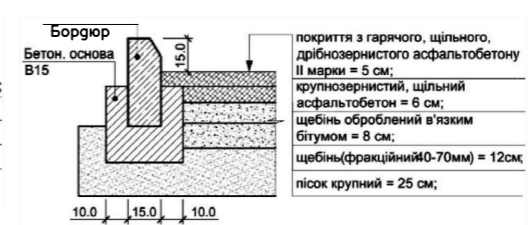
Конструкція дороги та проїздів
